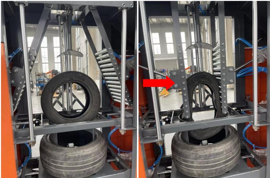
4. 同时按住下压气缸按钮，下压气缸把轮胎往下压，轮胎碰到平台瞬间按下滚轮前推按钮，配合下压气缸将小轮胎套入大轮胎种，一次未能成功套入可重复下压前推几次。
