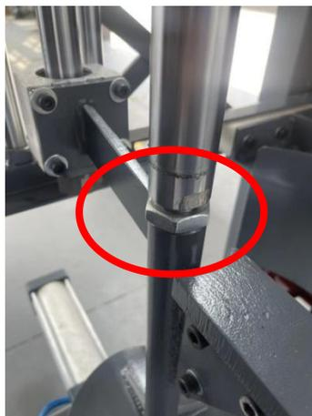
2、背部的气缸和顶部气缸一样，先拆螺丝，把活塞杆跟滑块扭紧，然后再用螺丝固定到后背对应的螺丝孔上，接着安装气管，就完成背部气缸的安装。
