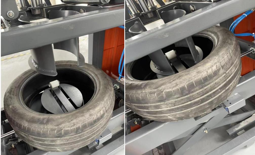
2. 按撑胎气缸, 4条撑胎气缸同时作用在轮胎的上下胎边, 把轮胎撑开, 固定住。
