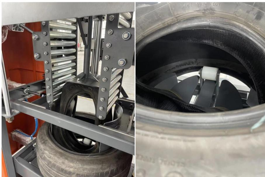
5. 重复以上动作就可以套进**第三第四**条胎，根据大轮胎的容量套上相应的小轮胎数，装满，一般装 4 条轮胎。把已套好胎的轮胎从平台拿下，就完成了个工作循环。
