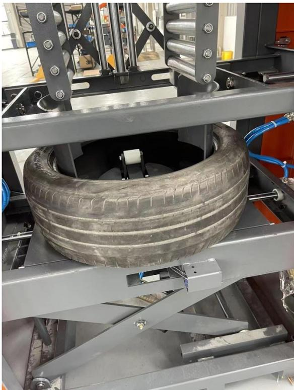
3. 把要套到大轮胎的小一号轮胎放到上台面，按下摆架气缸按钮，摆架下压，挤压住轮胎；
