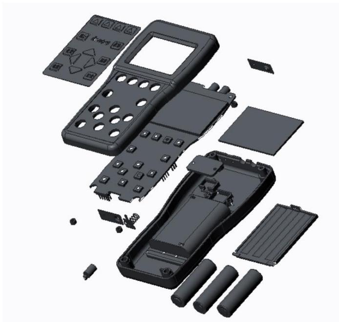
图 1 超声波测厚仪的结构图
